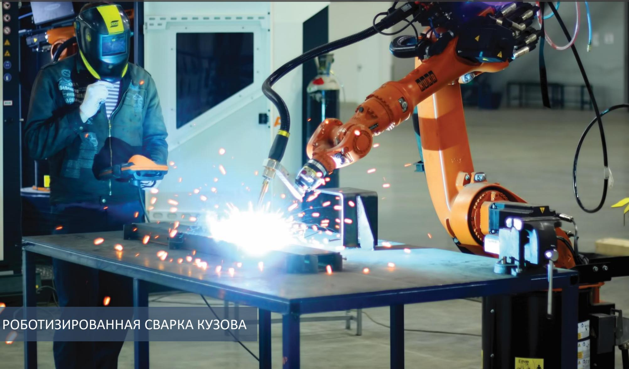
РОБОТИЗИРОВАННАЯ СВАРКА КУЗОВА
